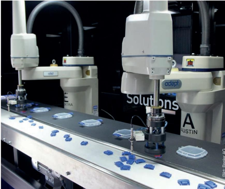
Bild 2 | Die Fertigungsroboter von Adept Technology erkennen automatisch, um welche Deckel und Clips es sich handelt.
