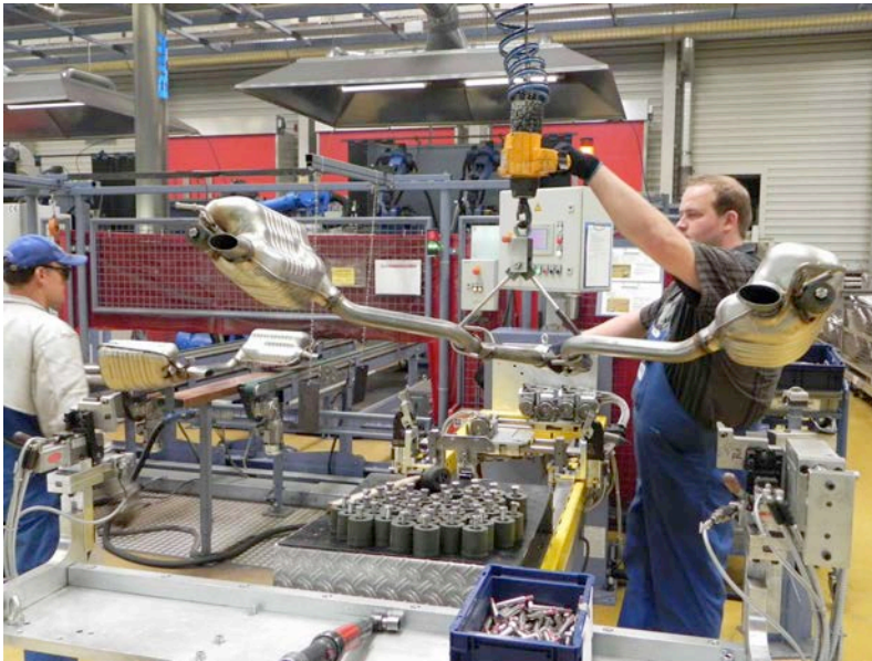
Fertigung kompletter Abgasanlagen Just-in-Sequence. Foto: Boysen Download als .zip-Datei
