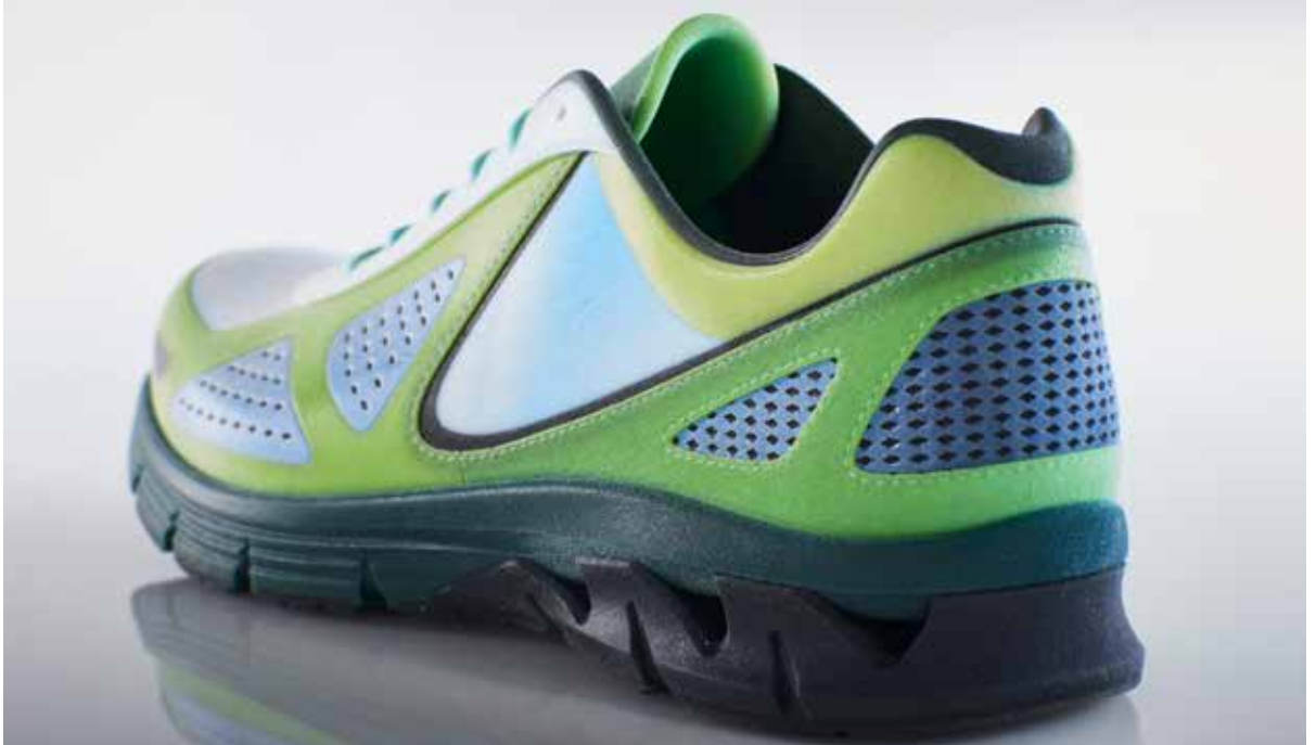
Figure 1. Cette paire de chaussures de sport tout en couleurs et multi-matériaux a été imprimée en 3D en une seule pièce et représente différentes valeurs Shore A.
