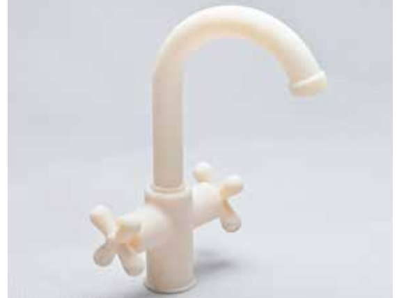
Figure 6. Le matériau Haute température est capable de supporter des liquides chauds.
