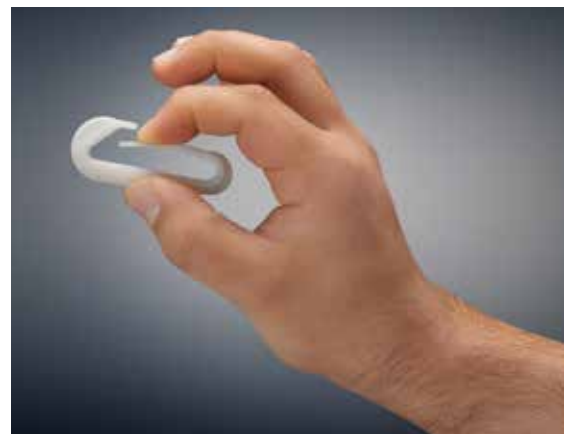
Figure 3. Le matériau Rigur a été conçu pour le prototypage de produits en polypropylène.
