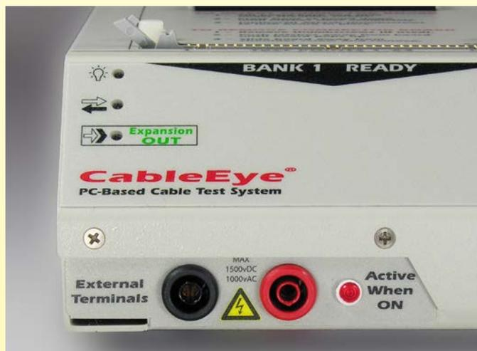
Terminales Externas para Prueba de Componentes
