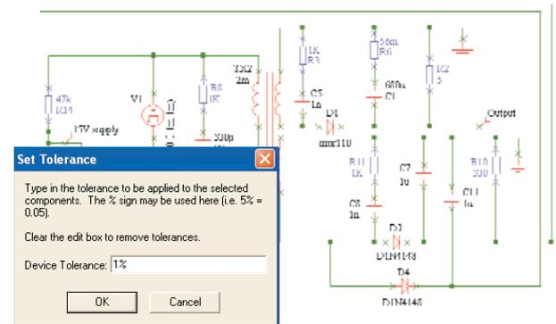
Simulation, bei der Bauteile innerhalb bestimmter Toleranzen arbeiten. Die prozentuale Toleranz wird eingegeben und die Schaltung wird mehrfach berechnet, wobei die Bauteilwerte bei jedem Durchlauf innerhalb des Toleranzbereiches automatisch variiert werden. Die resultierenden überlagerten Wellenformen ermöglichen dem Ingenieur die Beurteilung, ob die Schaltung unter Einfluss von Toleranzen nach den Spezifikationen arbeitet.
