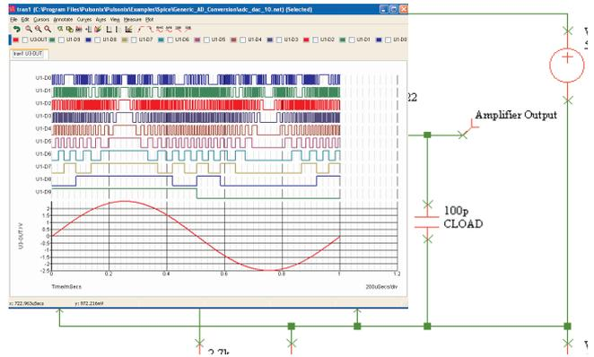
Leistungen durch einfaches Anklicken eines Punktes im Schaltbild erzeugt werden. Eine erneute Simulation ist nicht nötig wenn man einen weiteren Messpunkt benötigt. Alternativ können Messpunkte der Schaltung dauerhaft hinzugefügt werden so dass eine Grafik erzeugt und während der Simulation ständig erneuert wird.
