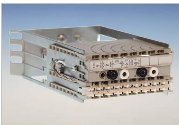
Los cables de comprobación son unidades independientes en el sistema de distribución y que son utilizados para diferentes mediciones o comprobaciones. Los cables de comprobación están instalados como bloques de distribución en los cuadros MDF. Con sus correspondientes cables de conexión, las señales que van a ser comprobadas están unidas al cables de comprobación y pueden ser medidas con los diferentes enchufes.
