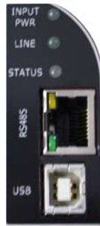
Modbus RTU (RS 485)
