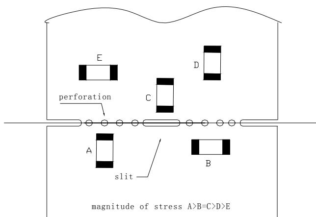
在沿着分拨线分拨电路板时，对产品施加的机械应力与使用的方法关系很大。分折电路板时片状元件受到的疲劳按照如下顺序增大：分折、剪切、V型槽、穿孔。因此，贴装时应该考虑电路板的分拨过程。
