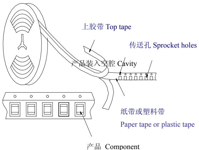
空白部分 Empty section    产品装入部分 Chip insertion section    空白部分 Empty section
