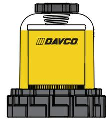
El elemento ahora está completamente cubierto de combustible. En este caso, toda el área de superficie de media está cubierta. La restricción esta aumento y el elemento del filtro deberá cambiarse en el próximo mantenimiento programado.
