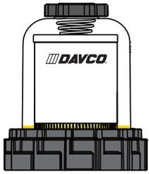
Quando nuevo el nivel de combustible en el filtro será muy bajo con restricción mínima. Al usarse el filtro, contaminantes coleccionan en el filtro de abajo hacia arriba. El combustible se eleva indicando la vida restante del filtro.
