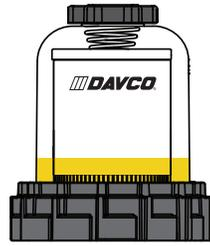
Nivel de combustible se eleva en la cubierta transparente. Mientras contaminantes se coleccionan en el filtro el combustible se eleva a una sección del filtro libre contaminantes, proveyendo filtración optimo manteniendo una restricción baja.
