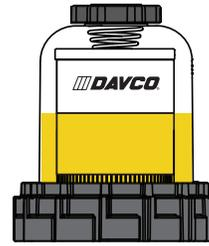
Nivel de combustible al nivel de la cubierta del filtro. Aunque el nivel de combustible es más que a la mitad del elemento del filtro, el combustible continúa fluyendo a través de media limpia restricción mínima. El filtro continúa con vida restante.
