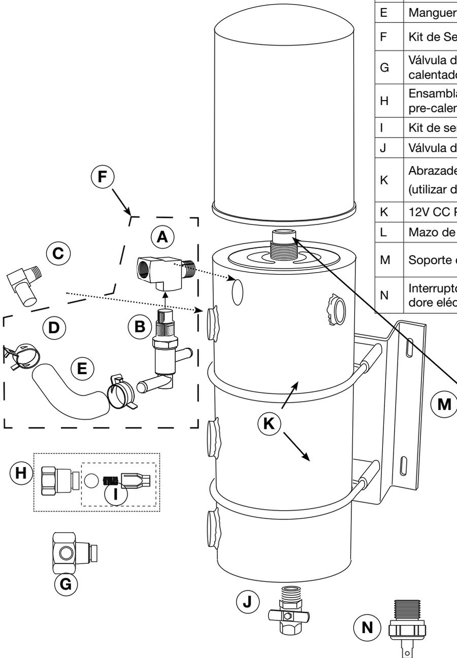
El filtro de emergencia debe de quedar dentro de la cubierta transparente y tenga las mismas dimensiones del tornillo dentro del cuerpo del procesador.
