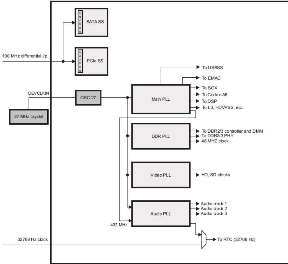
图 2 DM816x 系统时钟结构图
