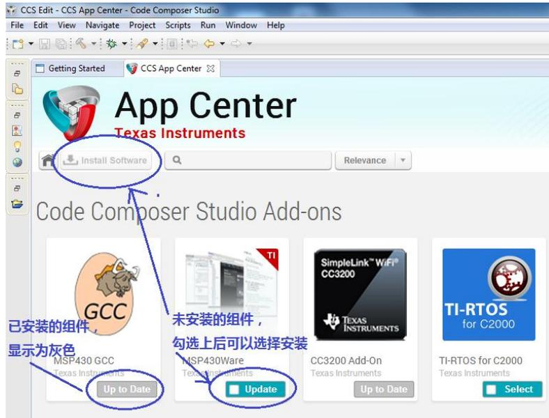
输入关键词'CC3200'查找相关组件，至少有两个组件“CC3200 Add-On”和“TI-RTOS for SimpleLink”；如下图所示，请安装好这两个组件。
