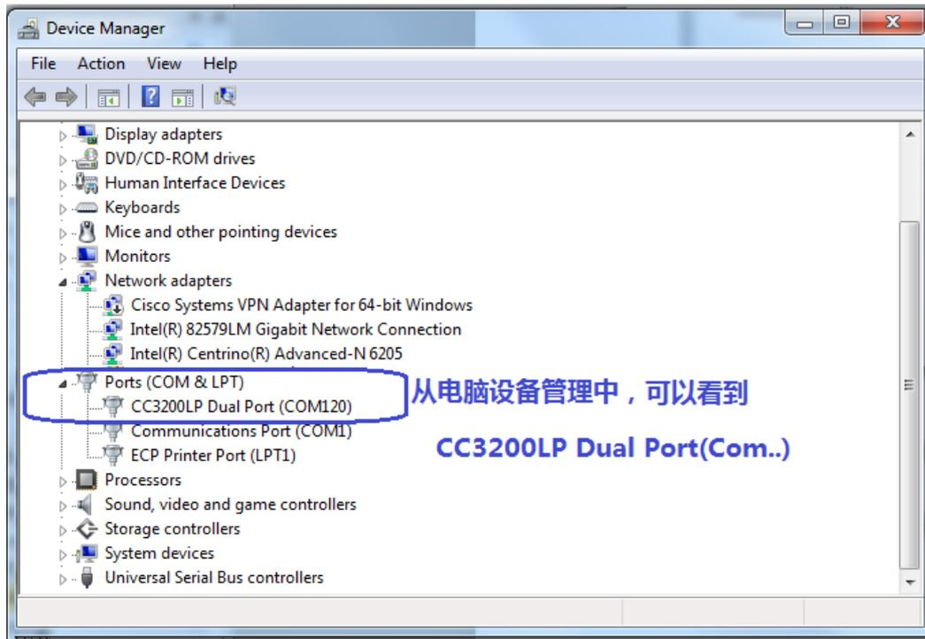
如果不能识别串口设备，可能原因是驱动程序未能正确安装，在 CC3200 SDK 安装目录下可以找到 USB 转串口芯片的驱动程序。
