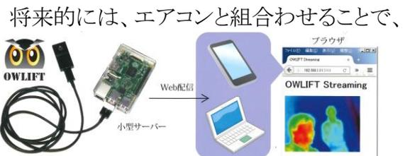
図2 サーマルカメラによる遠隔監視
