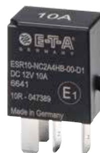
Das lautlose **Microrelais ESR10 Micro** von E-T-A kann mit positiver Spannung geschaltet werden. Die Ansteuerung ist bipolar und es kann mit Frequenzansteuerung betrieben werden.
