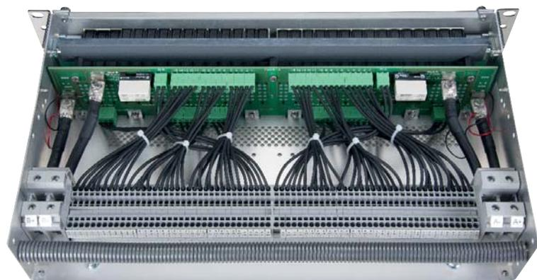
Baugruppenträger **Power-D-Box®**, Verdrahtung, Innenaufbau
