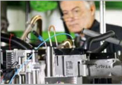
In den neuen Wasserheizungen Hydronic 2 Commercial und Hydronic M 2 wurden neben der neuen Technologie des Brennverfahrens auch das Gebläse weiterentwickelt und erstmalig mit einem bürstenlosen Motor angetrieben. Diese elektronisch kommutierte (EC) Motortechnologie garantiert höchste Laufzeiten.
