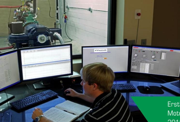
Erstklassige Anlagen zur Motorkalibrierung erlauben es uns, Motoren gemäß der Emissionsvorschriften Euro VI, USA EPA 2010 und für Large-Spark-Ignition-Motoren einzustellen.
