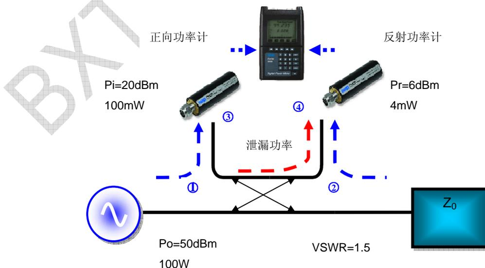
图 4：定向耦合器作为反射功率计
