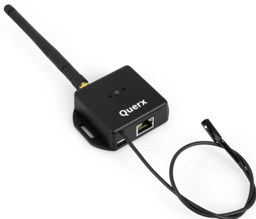
Querx WLAN TH ist ein Thermo-Hygrometer mit integriertem Datenlogger, Alarmfunktionen und zahlreichen Schnittstellen für den manuellen oder automatisierten Datenzugriff. Die Netzwerkanbindung erfolgt wahlweise über Netzwerkkabel oder WLAN.
