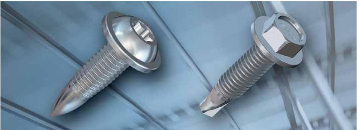
Die fließlochformende **EJOT FDS®** Schraube ermöglicht eine höherfeste Verbindung, bedingt durch einen hohen Gewindetraganteil im geformten Durchzug.
