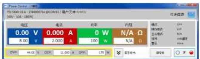
每个输入框的允许范围与产品前板手动操作允许输入的范围一样。保护极限的可调范围默认为对应额定值的 0...110%。如果输入参数太高或太低，则不会被接受，而是再次显示之前旧的参数。
