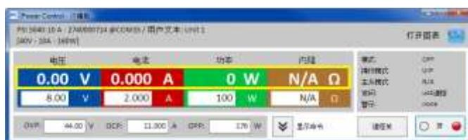
如产品上彩色 TFT 显示器所示，实际值之间是相互隔开的。在每一个单区，它们都位于上面一行（大字体）。彩色区域一般显示至少三组实际值。对于电子负载产品，它还显示实际内阻。
