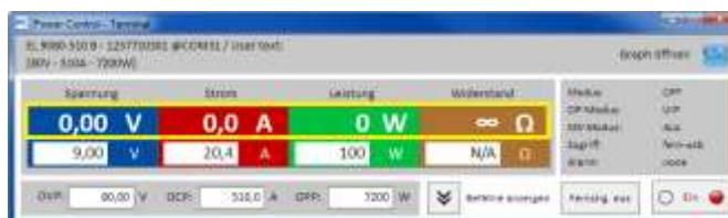
Ähnlich der Farbgebung auf der Anzeige bei Geräten mit TFT-Farbdisplay sind die vier Istwerte farblich voneinander abgegrenzt und werden in den Feldern jeweils oben dargestellt (große Zahlen). Dieser Bereich zeigt immer mindestens die drei Istwerte von Spannung, Strom und Leistung an. Bei elektronischen Lasten zeigt es zusätzlich noch den Widerstands-Istwert an.
