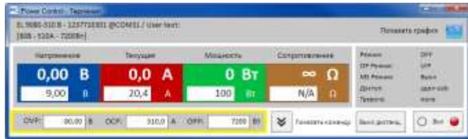
Допустимый диапазон значений на вводную ячейку идентичен тому, что устройство имеет на передней панели при мануальном использовании. Настраиваемый диапазон устанавливаемых значений всегда 0...102% относительно номинальных значений.
