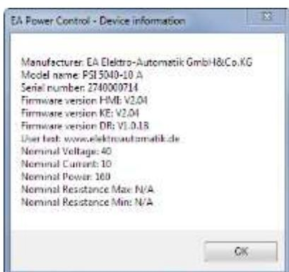
In dem Beispiel eines Netzgerätes der Serie PSI 5000 ist dann u. A. ersichtlich, daß das Gerät keinen Widerstandsmodus bietet, weil kein max. und min. Widerstand definiert ist. Oder daß kein Benutzertext (hier: User text) vergeben wurde, der dazu dient, mehrere identische Geräte unterscheiden zu können.
