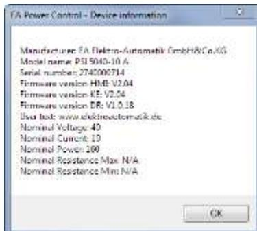
В этом примере с источником питания серии PSI 5000 видно, что устройство не имеет режима сопротивления (режим R). Вы так же можете видеть, что блок пока не имеет пользовательского текста. Пользовательский текст предназначен для идентификации нескольких идентичных устройств.
