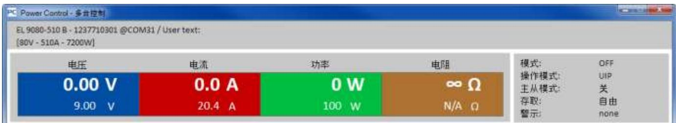
窗口顶部区域会显示被使用者在仪器列表上选定的仪器(蓝色，单一选定仪器)的实际值与设定值，这个窗口区域和“[终端机](#)”的窗口顶部区域相同。请参阅“[8.应用程序](#)”应用程序。
