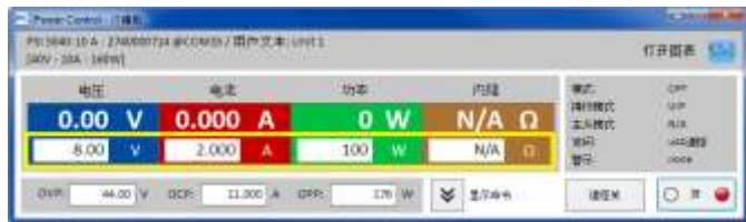
每个输入框内允许的参数范围与产品前板手动操作允许输入的范围一样。设定值的可调范围默认为 0...102%，可以被可调极限值缩减（缩写为：极限值）。这些参数即可通过产品的 MENU-菜单手动定义，也可通过 **EA Power Control** 软件的“设定”应用程序定义。
