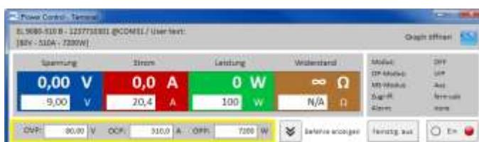
Die Felder für die sog. Schutzwerte (Protection) sind Anzeige- und Eingabefelder. Eingeben kann man Werte jedoch nur, wenn sich das Gerät zurzeit in Fernsteuerung über **EA Power Control** befindet. Der Zustand wird u. A. im Statusfeld mittels „Zugriff:“ angezeigt. Nach Umschalten auf Fernsteuerung werden die Eingabefelder freigegeben, um Werte im zulässigen Bereich per Tastatur eintippen oder auch in das Feld hineinkopieren (Copy & Paste) zu können.
