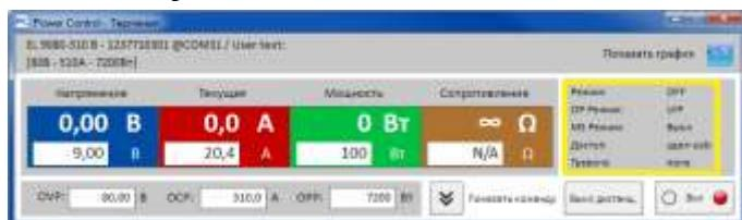
Участок статуса показывает копию статуса устройства, что отображен на его дисплее. Но здесь может быть небольшая разница. Например, устройство PSI 5000 показывает на дисплее Remote, неважно контролируется ли оно через аналоговый или цифровой интерфейс. Участок статуса отображает тип интерфейса в действии (смотрите ниже).
