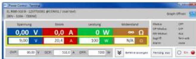
Die Felder für Sollwerte sind Anzeige- und Eingabefelder. Eingeben kann man Werte jedoch nur, wenn sich das Gerät zurzeit in Fernsteuerung über **EA Power Control** befindet. Der Zustand wird u. A. im Statusfeld mittels „Zugriff:“ angezeigt. Nach Umschalten auf Fernsteuerung werden die Eingabefelder weiß und man Werte im zulässigen Bereich per Tastatur eintippen oder auch in das Feld hineinkopieren (Copy & Paste).
