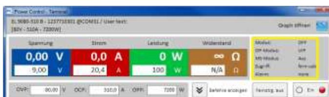
Der Bereich für Status zeigt eine Kopie des Status‘ an, den das Gerät in seiner eigenen Anzeige darstellt. Hierbei kann es leichte Unterschiede in der Benennung geben. So zeigt ein Netzgerät der Serie PSI 5000 z. B. in seiner Anzeige nur ganz allgemein „Remote“, wenn es sich in Fernsteuerung befindet, das Statusfeld hier im Fenster „Terminal“ gibt jedoch eindeutig die Schnittstelle an.
