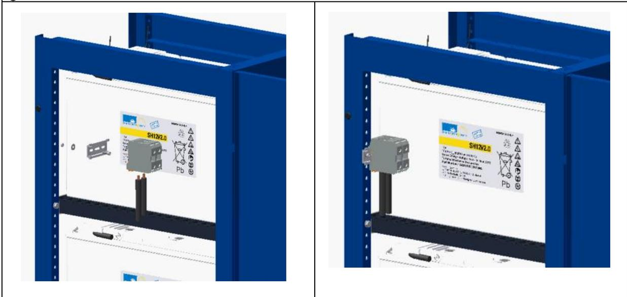
11: Tragschiene mit Reihenklammern für Messleitungen der Blockspannungen auf der Scharnierseite des Türrahmens montieren und Messleitungen anschließen.
