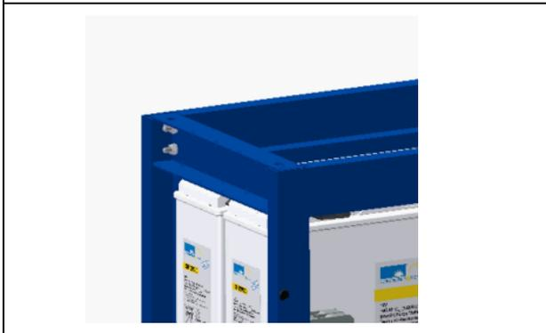
Abschließend die Schrankseite und danach den Schrankdeckel montieren.
