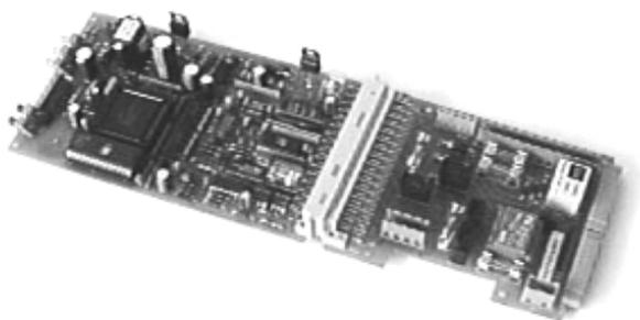
Für den Einbau in einen 19 Zoll Baugruppenträger sind die rechnergesteuerte Meßeinheit und die Übergabeeinheit achsial miteinander verbunden und werden im Baugruppenträger in einer gemeinsamen Führungsschiene gehalten. Die LED's und der 9-polige D-Substecker für die RS 232 Schnittstelle befinden sich in der Teilfrontplatte.
