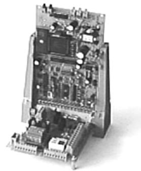
Für den Einbau auf einer Montageplatte/Chassis, wird die rechnergesteuerte Meßeinheit in einen Kartenhalter gesteckt und über eine Winkelsteckverbindung mit der Übergabeeinheit verbunden. Für den Anschluß zur Relaiseinheit sind Klemmen vorgesehen.
