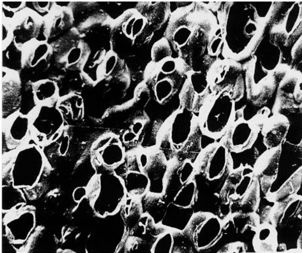
Abb. 16: Vergrößerung Separator im Maßstab 500 : 1 [3]
