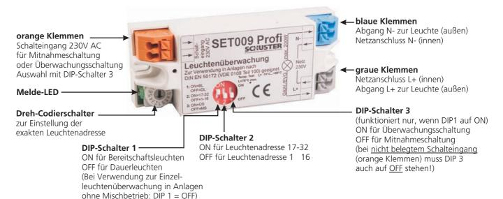
**Funktionsweise** Durch eine geeignete Steuerung kann mit Hilfe des **SET009 Profi** festgestellt werden, ob die an ihn angeschlossene Leuchte betriebsbereit oder defekt ist. Zusätzlich kann die angeschlossene Leuchte im Mischbetriebskreis als DL oder BL definiert werden (Auswahl mit DIP-Schalter 1). Als weitere Option ist eine Schaltung integriert, welche wahlweise als Mitnahme- oder Überwachungsschaltung genutzt werden kann (für BL in Mischbetrieb).
