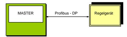
Es ist möglich, die Mehrzonentemperaturregler über Profibus-DP nach EN 50170 durch einen Master (z. B. einen Industrie- oder Personal-Computer oder eine SPS) überwachen und steuern zu lassen.
