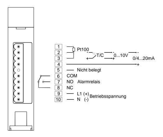
Das Gerät wird über die Stiftleiste auf der Gehäuseunterseite angeschlossen.
