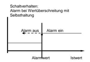
Bei aktiver Selbsthaltung blinkt die Alarm-LED (rot).
