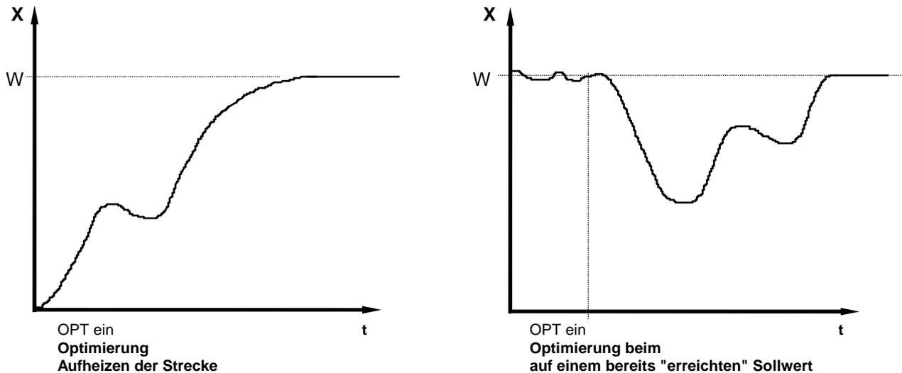
Durch Anwahl von OPT=OFF und Betätigen der "E"-Taste kann ein Optimierungsvorgang abgebrochen werden.
