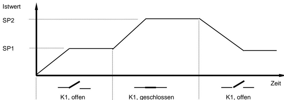
**A1 Alarmwert A1** (wirkt auf OUT A1) **Temperaturüberwachung** (Schaltpunkteinstellung)
