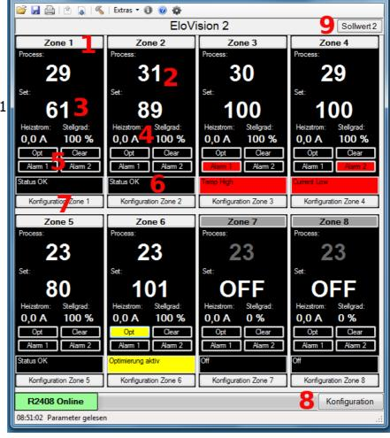
Durch Betätigen des Tasters Sollwert 2 9 wird der 2. Sollwert für den Regler eingeschaltet. Bitte beachten Sie: Damit eine Zone auf den 2. Sollwert geschaltet werden kann, darf der Zonenparameter "Sollwert 2" der entsprechenden Zone nicht auf "aus" stehen.
