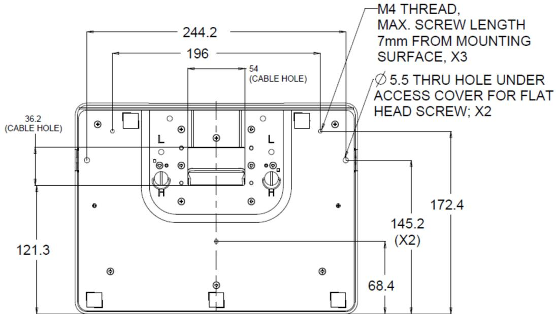
Sur l'écran tactile 2002L, des trous filetés sont présents sur la partie inférieure de la base du socle pour le monter ou le fixer.
