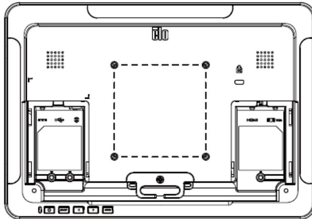
Pour l'écran tactile 1502L & 2002L, un schéma de montage à quatre trous 75x75 mm et un de 100x100 mm sont disponibles pour les vis M4 à l'arrière du moniteur. Retirez le support à l'aide d'un tournevis cruciforme pour accéder à cette interface de montage. Le comptage VESA conforme FDMI est codé : VESA MIS-B, 75, C et VESA MIS-B, 100, C.
