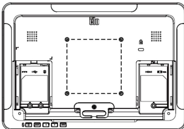
Sulla parte posteriore del touchmonitor da 1502L & 2002L è disponibile uno schema di montaggio a quattro fori da 75 x 75 mm e 100 x 100 mm per viti M4. Rimuovere il supporto con un cacciavite a stella per accedere a questa interfaccia di montaggio. Il montaggio compatibile VESA FDMI è codificato: VESA MIS-B, 75, C e VESA MIS-B, 100, C.
