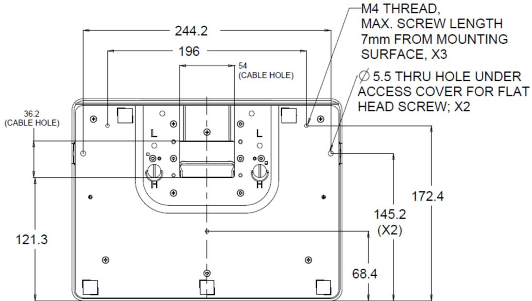
Per il touchmonitor 2002L, sulla parte inferiore della base sono predisposti fori filettati per il montaggio o il fissaggio.
