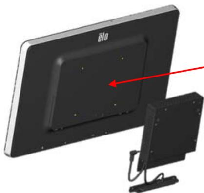
Модуль расширения устанавливается на заднюю панель системы I-Series
