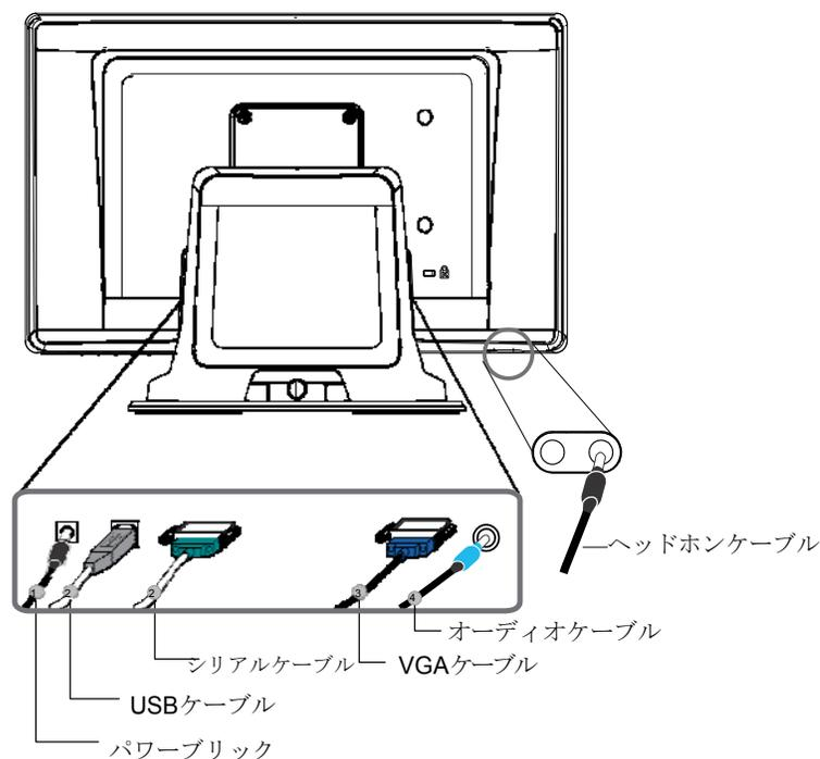
1. パワーブリックのAC電源ケーブルをモニターに接続し、もう片方のAC電源ケーブルをAC電源（コンセント）に接続します。
