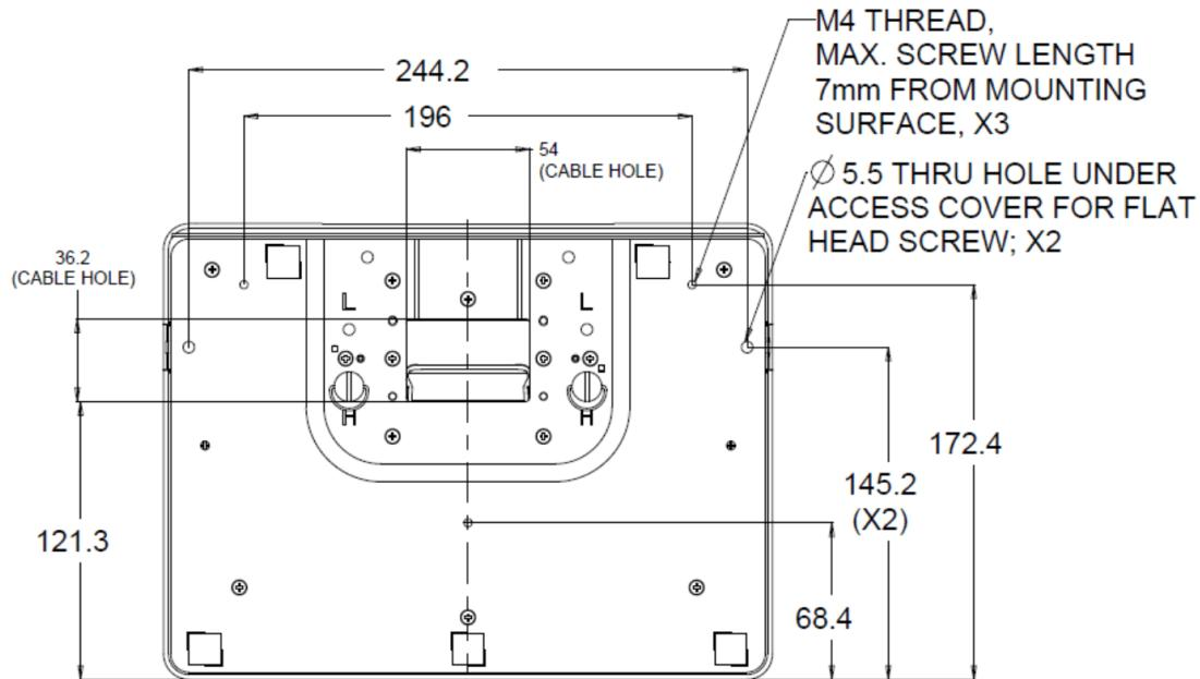
对于 2002L 触摸显示器，在底座下部提供了用于安装或固定的螺纹孔。
