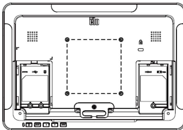
对于1502L & 2002L的触控一体机，在显示器后部提供了适用于M4螺丝的四孔75x75mm和100x100mm安装模式。使用飞利浦螺丝刀拆下支架，以进入该安装接口。符合VESA FDMI标准的计数编码为：VESA MIS-B, 75, C和VESA MIS-B, 100, C。
