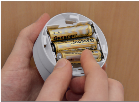
Bild 22: Entfernen Sie den Batteriefachdeckel am Bewegungsmelder und legen Sie die beiliegenden Mignon-Batterien polungsrichtig ins Gerät ein.
