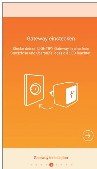
Bild 3: Stecken Sie das WLAN-Gateway in eine freie Steckdose innerhalb der WLAN-Empfangsreichweite Ihres WLAN-Routers.
