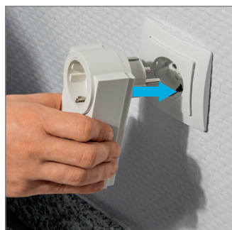
Bild 29: Notieren Sie sich die Seriennummer des Homematic Schaltaktors mit Leistungsmessung für das spätere Anlernen und stecken Sie diesen dann in die Steckdose ein.
