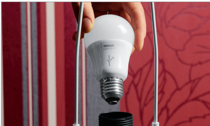
Bild 8: Schrauben Sie die 10-W-RGBW-LED-Lampe in eine Leuchte mit E27-Fassung.
