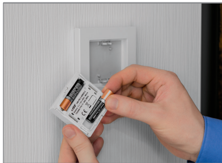
Bild 26: Legen Sie die beiliegenden Micro-Batterien polungsrichtig in den Wandsender ein.
