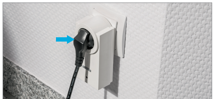
Bild 30: Stecken Sie nun den Stecker Ihres Fernsehers in den Zwischenstecker-Schaltaktor ein und testen Sie das Gerät mit der Bedientaste am Gerät. Starten Sie den Geräte-Anlernmodus wie unter Bild 31 beschrieben, und lernen Sie das Gerät durch Eingabe der Seriennummer an.
