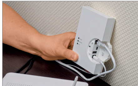
Bild 16: Um die CCU für den Anschluss an den Router vorzubereiten, schließen Sie das im Lieferumfang enthaltene Netzwerkkabel und das Anschlusskabel des Netzteils an die CCU an.
