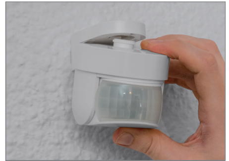
Bild 24: Setzen Sie den Bewegungsmelder in den Wandhalter ein und richten Sie diesen aus. Der Bewegungsmelder hat einen Erfassungsbereich von 9 m und 90°.
