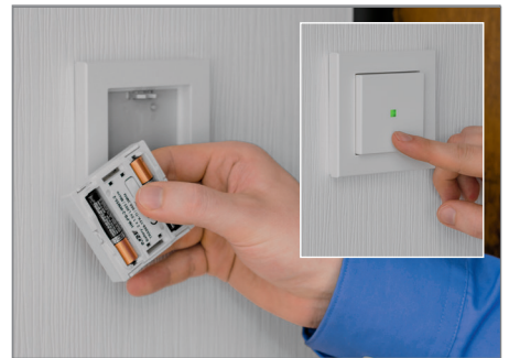
Bild 27: Nachdem Sie wie unter Bild 31 beschriebenen den Anlernmodus Ihrer CCU aufgerufen haben, lernen Sie den Wandsender durch kurzes Betätigen der Anlern-taste auf der Rückseite des Geräts an. Abschließend setzen Sie den Wandsender auf die Montageplatte auf.
