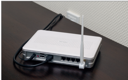
Bild 15: Zum Anschluss der CCU benötigen Sie einen Router mit freiem LAN-Anschluss, um die CCU in Ihr Heimnetzwerk zu integrieren. Hierüber können Sie dann von jedem PC oder Smartphone aus auf die CCU zugreifen.
