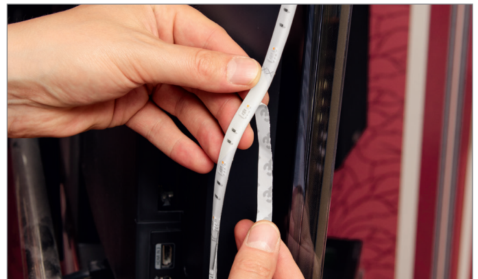
Bild 9: Befestigen Sie den 1,8-m-RGBW-LED-Streifen mit dem selbstklebenden Streifen auf dem gewünschten Objekt. Achten Sie dabei auf einen staub- und fettfreien Untergrund.
