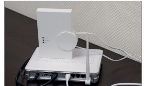
Bild 17: Verbinden Sie abschließend das Netzwerkkabel der CCU mit dem Router und stecken Sie das Netzteil der CCU in eine Netzsteckdose. Die CCU führt nun den Boot-Vorgang durch.
