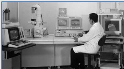
Microscope électronique à balayage
