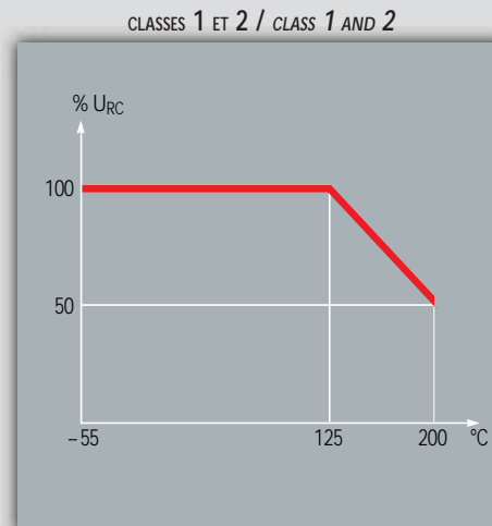
Fig. 43 bis Derating de la tension à 200°C. Voltage derating at 200°C.
