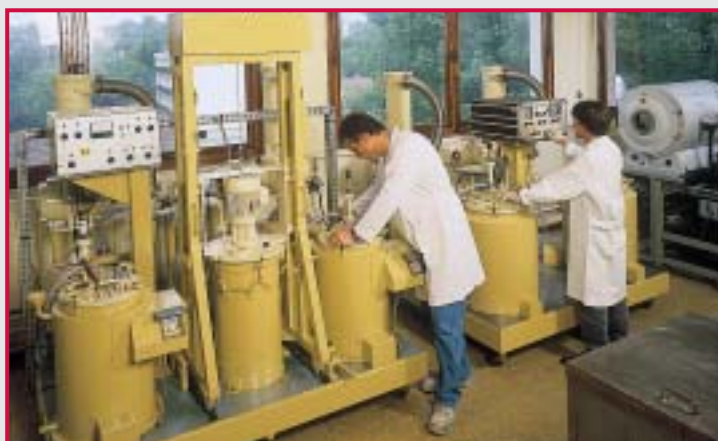
Stands d'imprégnation haute tension
