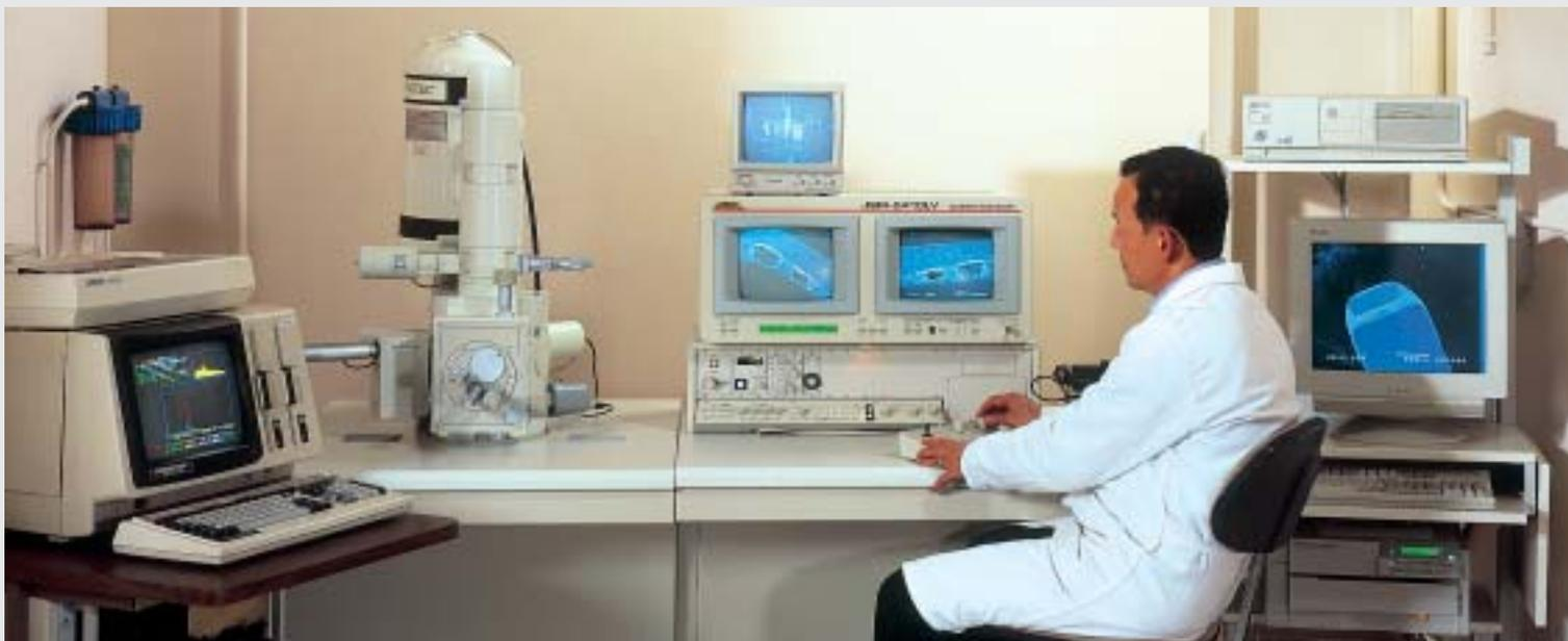
Microscope électronique à balayage
