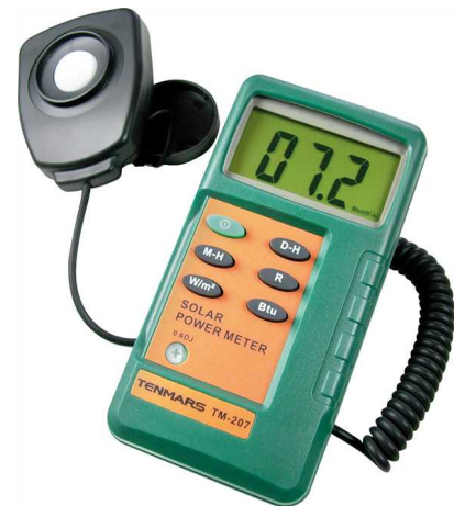
C-7304 Digital solarimeter. 3 ½ digit
