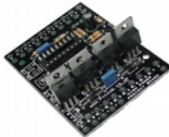
Este protoboard del micro-controlador PICAXE 18M2, dispone de 4 mosfet de salidas. Micro PICAXE, y cable USB PICAXE. **NO INCLUIDO**
