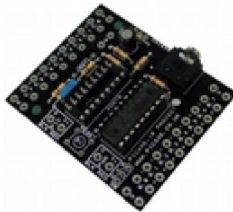
Este pequeño protoboard on el micro-controlador PICAXE 18M2. Dispone de ULN 2803 de salida Micro PICAXE, y cable USB PICAXE. **NO INCLUIDO**
