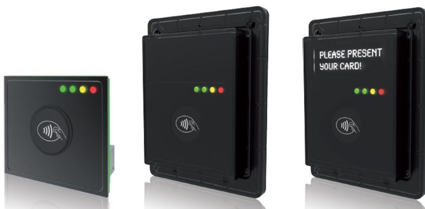
Die cVEND plug Module sind sehr kompakt und für den flächenbündigen Einbau in Gehäuse aus Glas oder Kunststoff vorgesehen. In Validatoren öffentlicher Verkehrsmittel oder Bordcomputern ist dann nur das Symbol für kontaktloses Bezahlen (28,5 mm Durchmesser) sichtbar. Die Modelle cVEND box und die cVEND box+ können direkt in Metallgehäuse von Bordcomputern, Ticketing- und Verkaufsautomaten sowie Zugangssysteme integriert werden.
