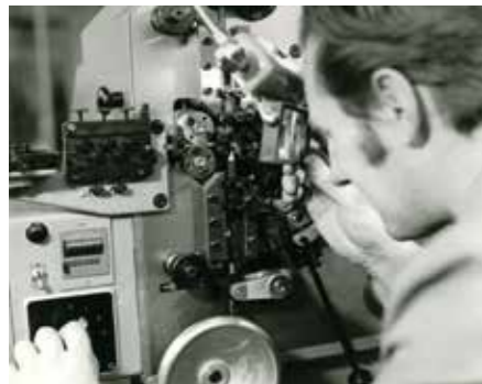
HERSTELLUNG VON ZYLINDERSPIRALEN PRODUCTION OF CYLINDRICAL COILS
