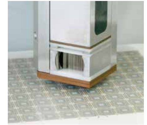
ERSTE KNICKDRAHT-PRÜFKÖPFE ZUR KONTAKTIERUNG („BUCKLING BEAM TECHNOLOGIE“) FIRST BENT WIRE PROBES FOR MAKING CONTACT („BUCKLING BEAM TECHNOLOGY“)
