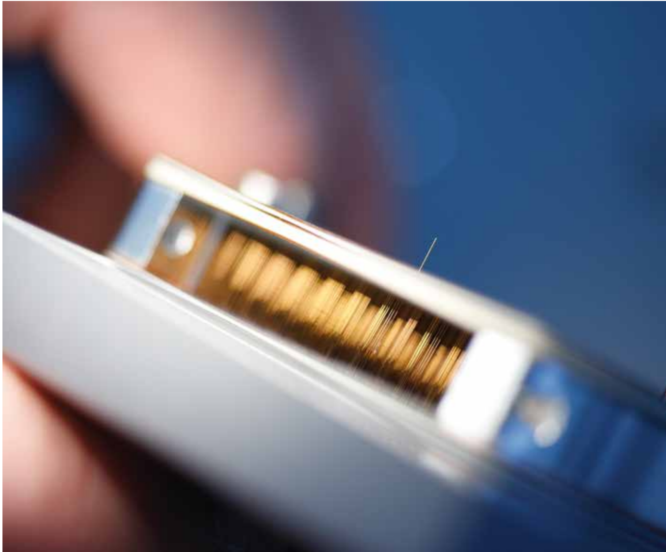
PRÜFKOPF EINER VERTIKALEN PRÜFKARTE TEST HEAD OF A VERTICAL TESTING BOARD
