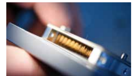
PRÜFKOPF EINER VERTIKALEN PRÜFKARTE TEST HEAD OF A VERTICAL TESTING BOARD
