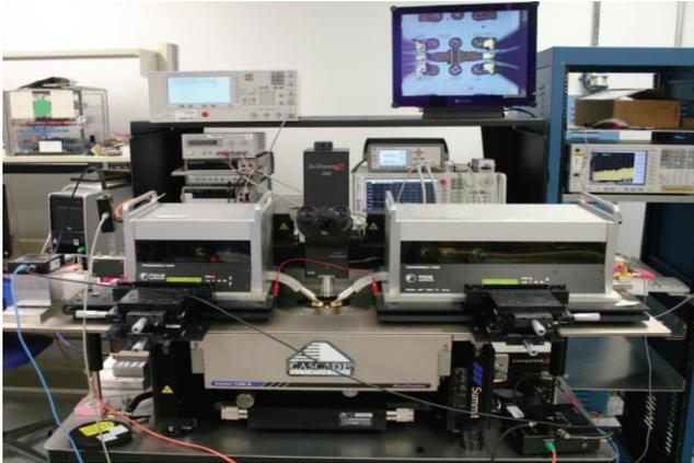
Рис. 8: Гармонический load pull на пластине
