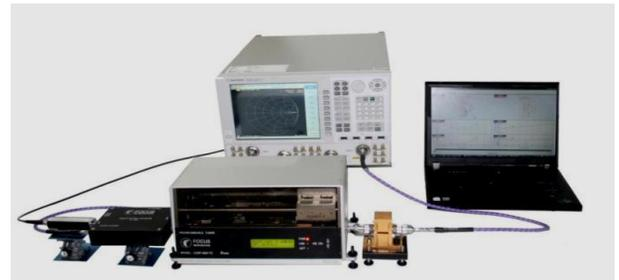
Широкополосная система параметров шума с использованием векторного анализатора цепи PNA-X (Agilent), CCMT-2607 Focus тюнера 0,7-26 ГГц, источника шума и устройства входного шума. PNA-X поддерживает опции 28, 29. Может измерять параметры шума быстрее 1сек./частотную точку
