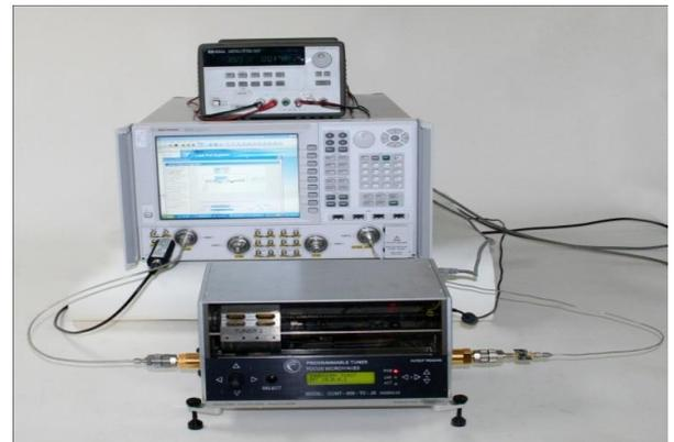
Рис 18: Система измерения параметров шума.
