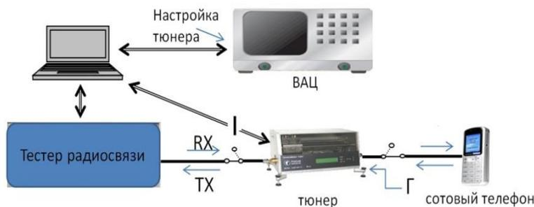
Рис.30- Схема испытания сотового телефона
