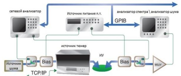
Рис 17: Типичная схема системы измерения параметров шума.
