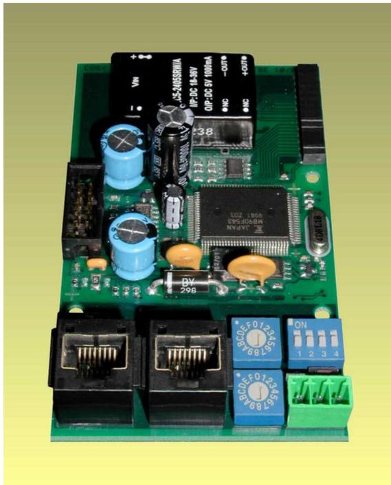
Das Buskoppelmodul VarIO-COxx stellt die Verbindung der Vario-I/O-Module zu einem CANopen Netzwerk her. Dabei arbeitet der Buskoppler mit den CANopen- Protokollen bzw. Standards nach DS301 und DS401.
