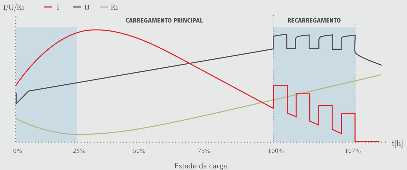
Através do ajuste da corrente na bateria, perdas de carga no início do carregamento assim como na fase pós-carregamento podem ser evitadas. A bateria só recebe a corrente que ela realmente precisa.
