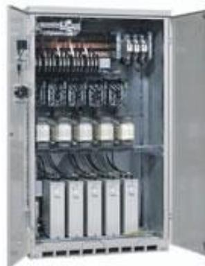
Le condensateur est muni d'un interrupteur de thyristor, qui remplace le contacteur traditionnel. Des opérations régulières sont combinées avec les contrôles de thyristors automatiques. Cet équipement peut compenser rapidement pour les fluctuations de puissance réactive rapides dans les machines à soudure et les variations de tension conséquentes.
