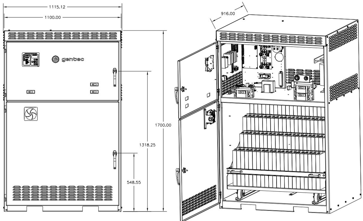
**Note 3:** de base, le support de la batterie est fixe, le support mobile est une option. Les louveres sont aussi en option.
