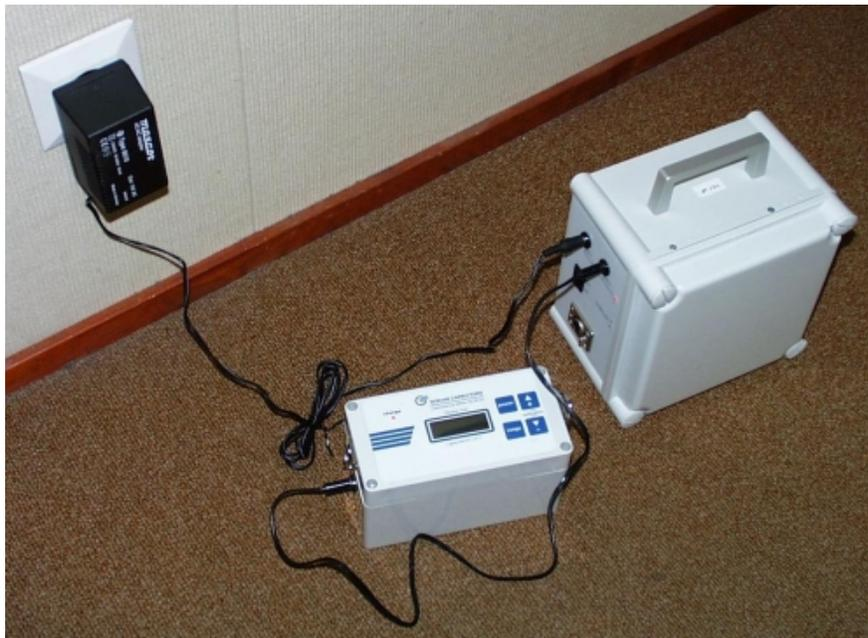
Le chargeur peut également être employé séparément avec l'une ou l'autre des unités. Il y a deux prises de connecteur de chargeur du côté de l'unité de générateur, une peut être employée pour le raccordement du chargeur et l'autre pour fournir la charge à l'unité d'affichage en utilisant le câble d'interconnexion fourni avec l'appareil.
