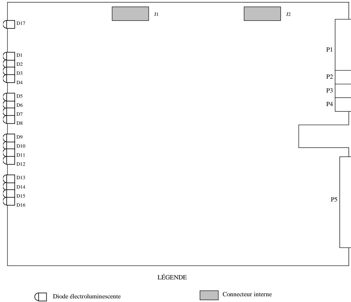
Figure 3-8 Schéma d'encombrement de la CEN3
