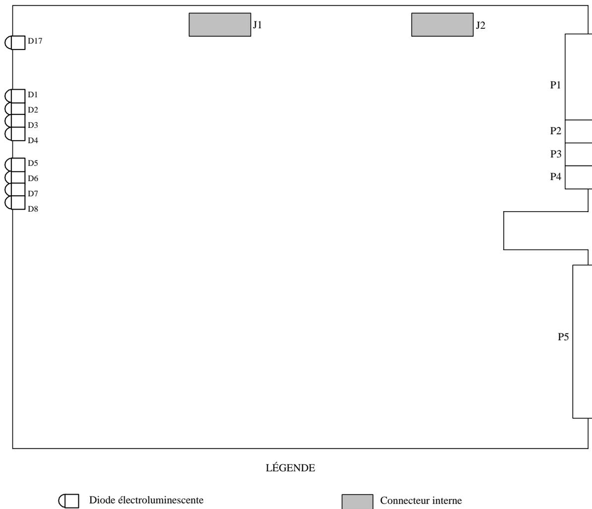
Figure 3-9 Schéma d'encombrement de la CSR3
