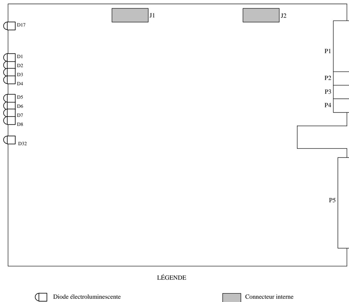
Figure 3-11 Schéma d'encombrement de la CNP3
